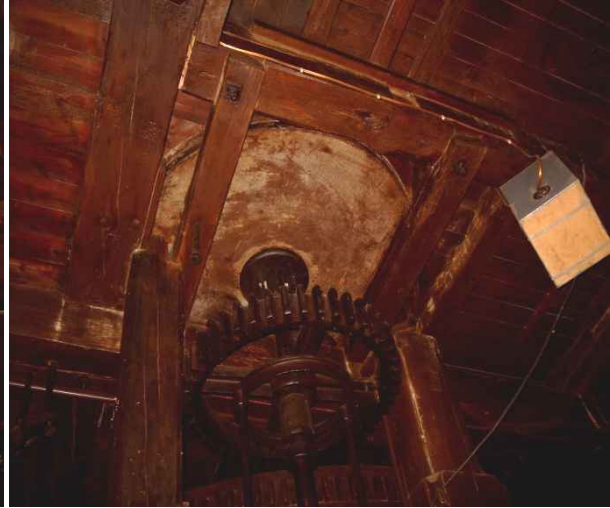
Eisernes Ritzel zum Betrieb des Schrotgangs.
