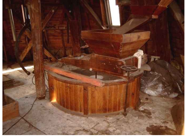
Schrotgang mit altem Rumpfzeug und Steinkran daneben. Auf der Bütte liegt ein Richtscheit zum Abrichten der Mahlbahnen des Fabrikats Roger / Hamburg.
