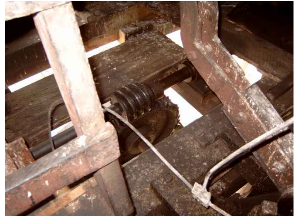
Schneckenvorgelege zur Ritzelwelle vom Windrosengetriebe (späterer Umbau).
