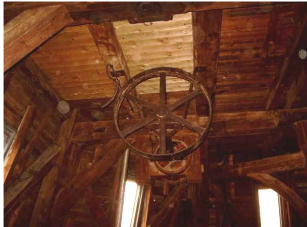
Transmission zum Betrieb des ehemaligen Flachsichters, der Mischmaschinen und Elevatoren.
