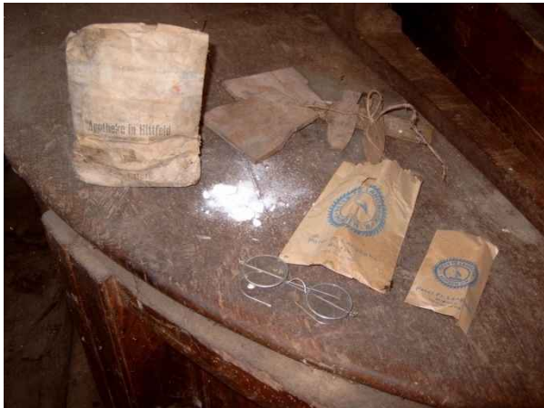
Steineschärfbrille, ungebrauchtes Alaun zum Eingießen der Haue in den Läuferstein und Schablonen der Kammköpfe für das Stirnrad.
