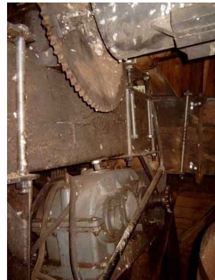
Ölbadgetriebe unter dem Penbalken und Kettenrad auf der Flügelwelle zum Antrieb des Generators.
