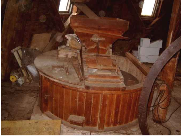
Schrotgang mit altem Rumpfzeug und Steinkran daneben. Auf der Bütte liegt ein Richtscheit zum Abrichten der Mahlbahnen des Fabrikats Roger / Hamburg.
