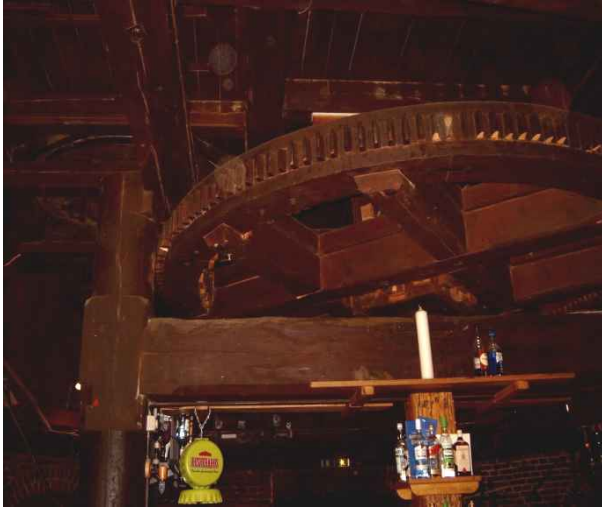
Unteres Lager der Königswelle mit Stirnrad, auffallend massive Tragkonstruktion nach mecklenburgischem Vorbild.
