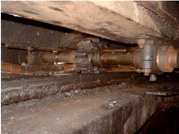
Drehkranz (Gleitkranz) mit Ritzel vom Windrosengetriebe.
