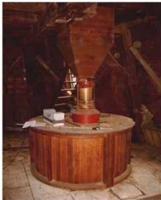
Backschrotgang mit Speiseapparat „Victoria“ der Firma Wetzig / Wittenberg.
